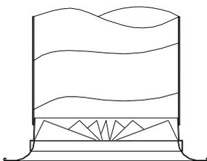
1) Fixação directa a conduta circular metálica através de rebites.
